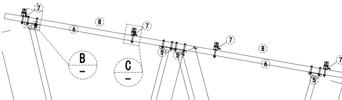
Coloque las 8 guías de raíl encima del travesaño y atorníllelas con los tornillos M12\*90.
